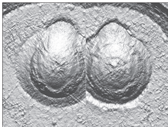
Slika 11: Podobnosti sledi udarnih igel med b5_6 in b9_2
