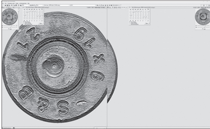
Slika 9: Primer ujemanja sledi posnemanja na čelih zaklepov med b5_6 in b5_2
