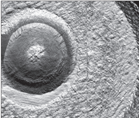
Slika 12: Podobnost sledi na čelih zaklepov med a4_4 in a7_5
