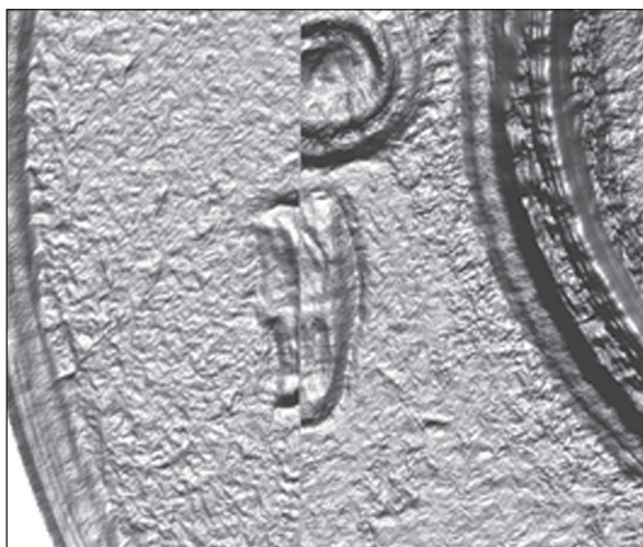
Slika 10: Podobnosti sledi izmetal med a1_1 in a6_6
