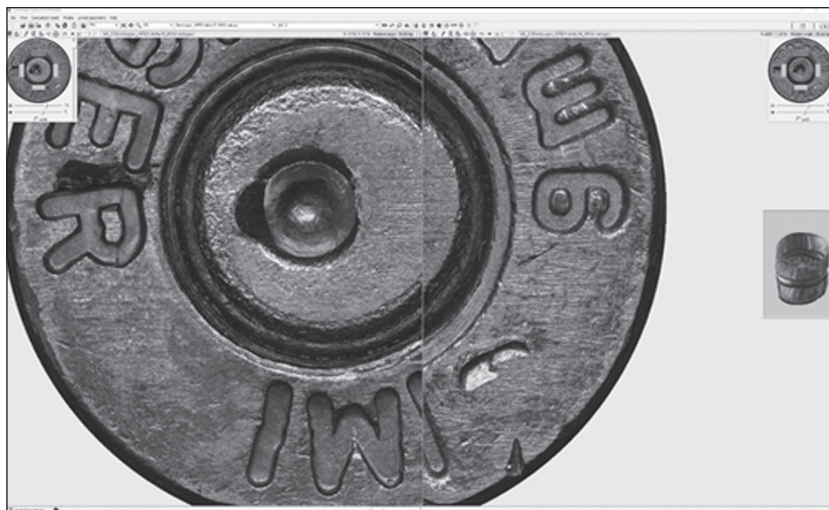
Slika 13: Ujemanje sledi na netilkah med b6_3 in b8_3
