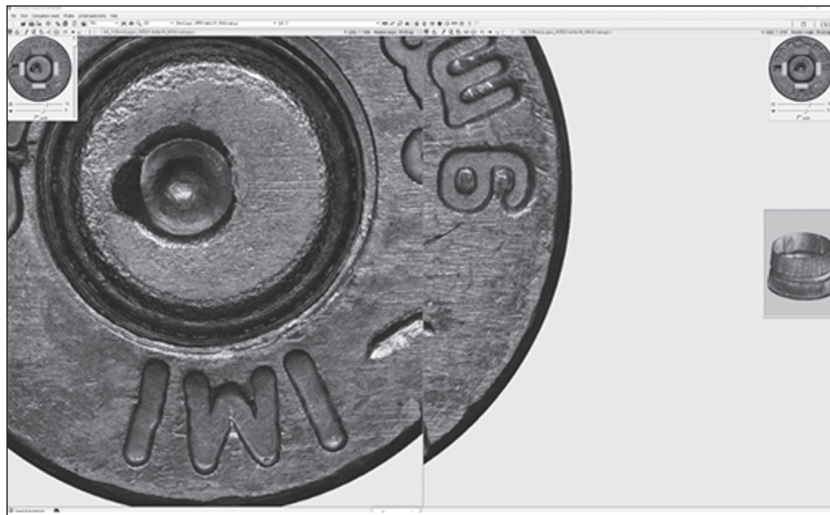
Slika 14: Neujemanje sledi čel zaklepov med b6_3 in b8_3
