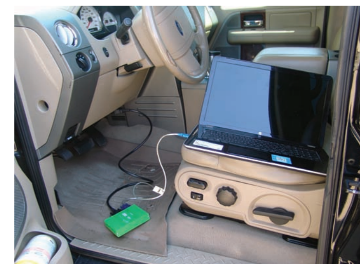
Slika 3: Zavarovanje podatkov prek priključka diagnostike vozila (Vir: Event data recorder imaging, b. d.)
