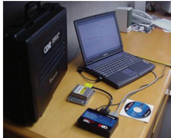
Slika 4: Prikaz neposredne priključitve orodja na modul zapisovalnika (Vir: Vehicle black box analysis, 2020)
