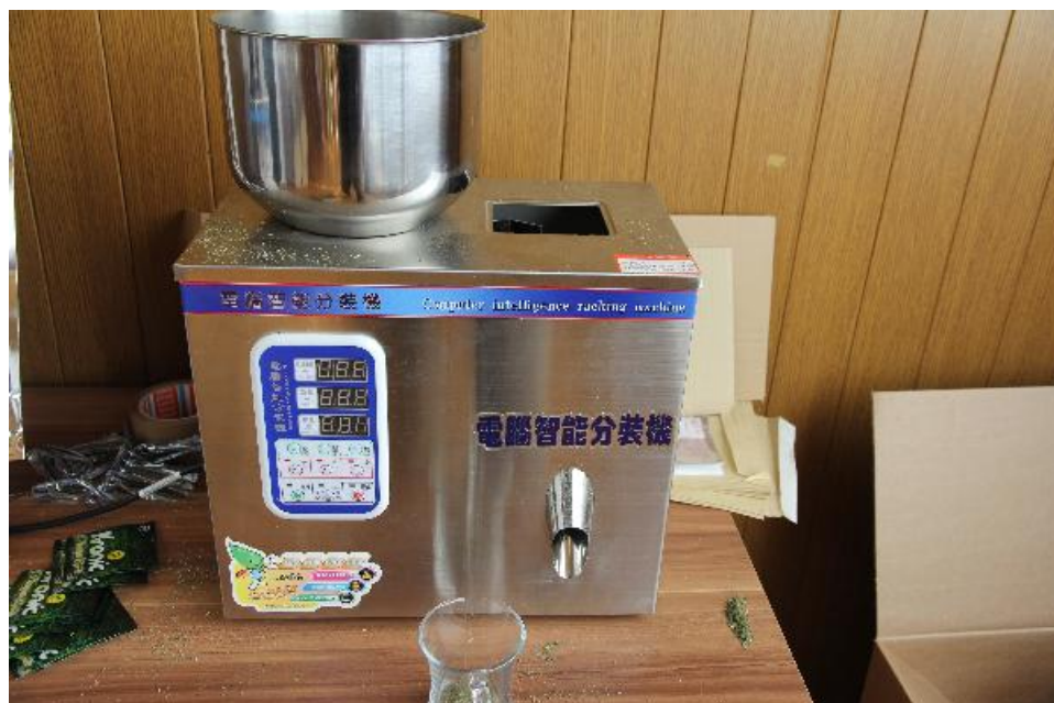
Slika 11: Strožček za pakiranje zeliščnih mešanic in vrečke za proizvod Kronica, najdeno v proizvodnih prostorih v Ljubljani
